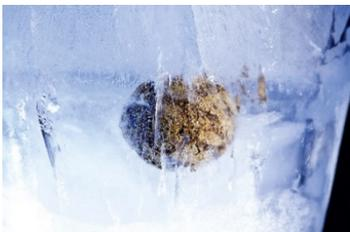
**Blähton schützt sich selbst vor Wasserschäden.** Blähton schwimmt auf Wasser. Das liegt zum einen daran, dass Blähton leichter ist als Wasser, zum anderen daran, dass jedes einzelne Blähtonkügelchen über eine spezielle Außenhaut verfügt, die Wasserdampf zwar durchlässt, aber aktiv verhindert, dass sich das Tonkügelchen (und damit auch die Wand) mit Wasser vollsaugt. Gut bei Wasserschäden, Hochwasser und Starkregen. Blähton hat unter allen Mauersteinen das geringste Wasseraufnahmeverhalten.
